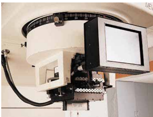
Figura 7: Colimador multi-láminas MIMiC™
